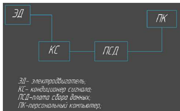
Рис. 1. Структурная блок-схема комплекса диагностики работы электродвигателя
